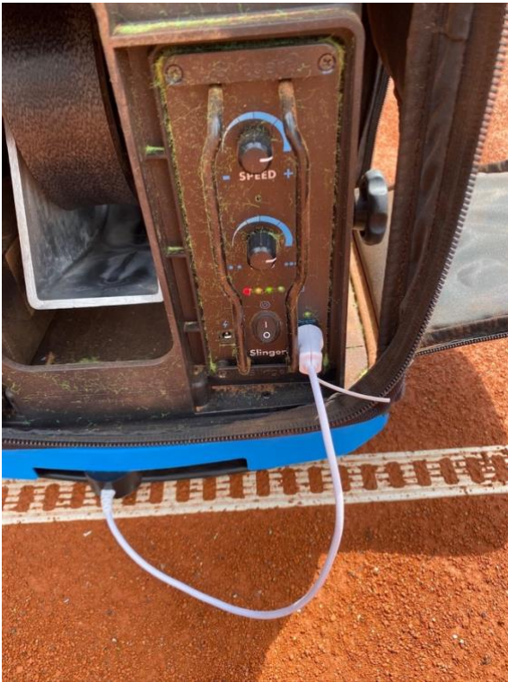
Angeschlossene Bodenplatte nur ein Magnetstecker
